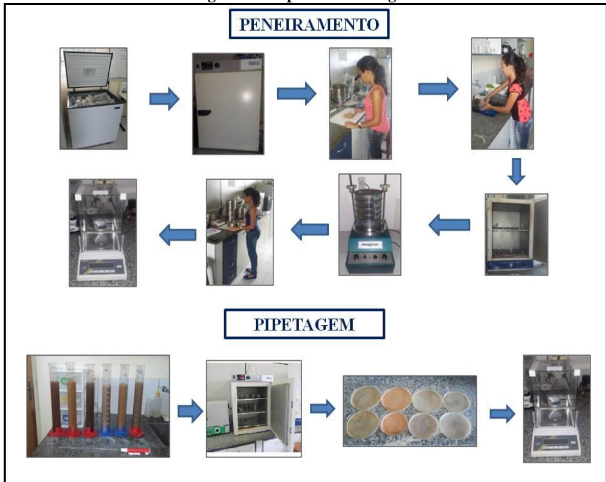
Figura 5- Etapas da análise granulométrica
