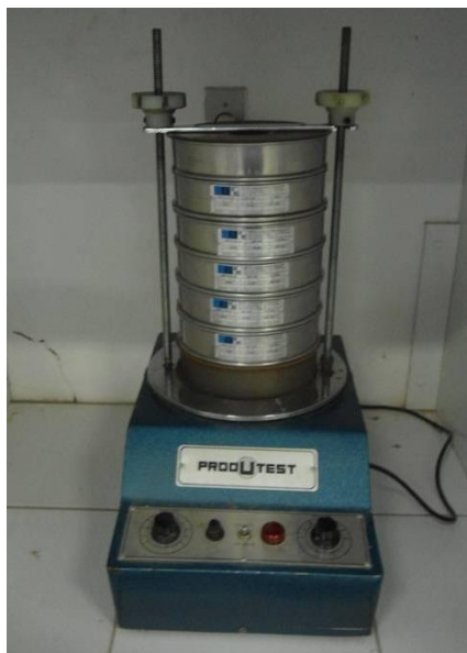
Foto 5 – Peneiras e Agitador de Peneiras RO – TAP e escala comparativa de phi e mm.
