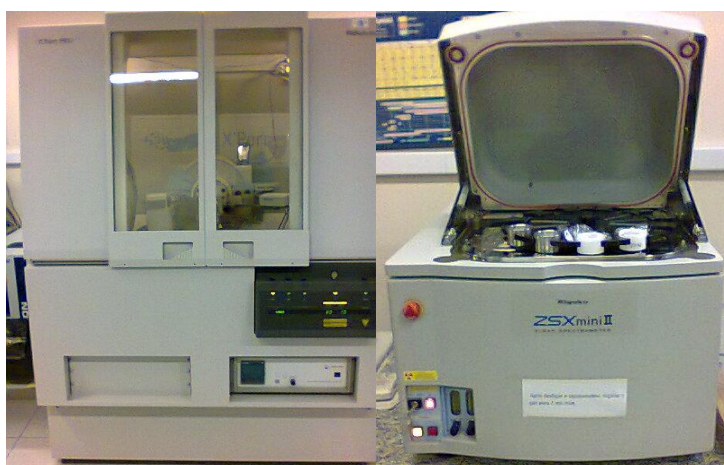
Foto 25 - Espectrômetro de fluorescência de Raios-X Marca: Rigaku Modelo: ZSX Mini II Operação: 40 kV x 1,2mA. Tubo de Pd Difratorômetro de raios-X Marca: Rigaku
