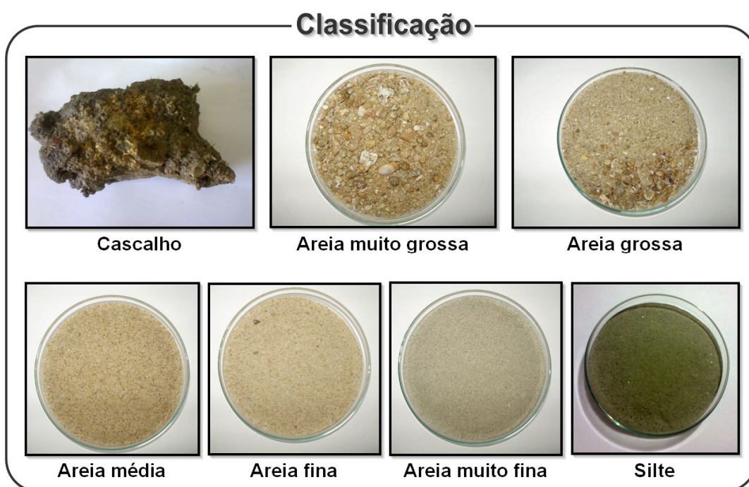
FIGURA 31 – Classificação granulométrica dos sedimentos coletados em campo – 18/03/2011 a 20/03/2011
