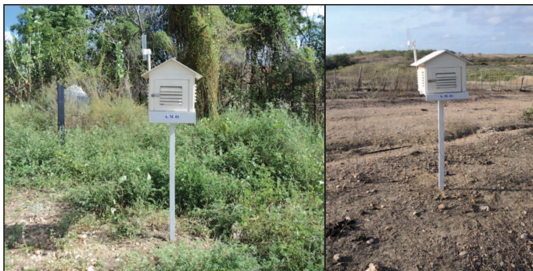
Figura 14: Abrigos microclimáticos instalados durante o período seco próximo ao lago nos Municípios de Alto Santo e Jaguaretama, respectivamente. Fonte: Trabalho de campo, 2011.
