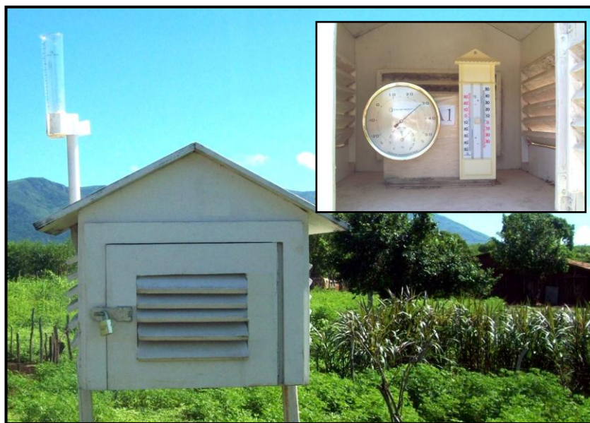
Figura 10 – Exemplo de posto meteorológico, apresentando o abrigo e a disposição de seus instrumentos.
