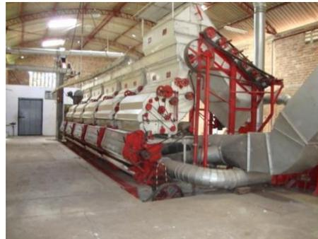
FIGURA: Máquina de descaroçar algodão
