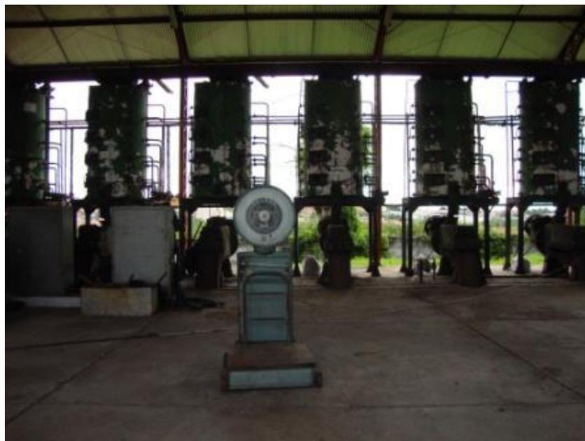
FIGURA: Caldeira de preconzimento da torta do algodão e retirada do óleo do algodão
