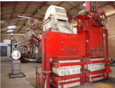
FIGURA: Máquina de prensar algodão
