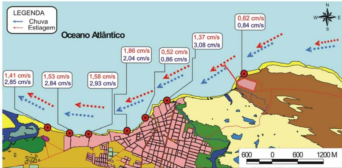
Figura 20: Direção da Corrente Longitudinal no litoral de Paracuru. Fonte: dados obtidos pela aplicação da equação 1.
