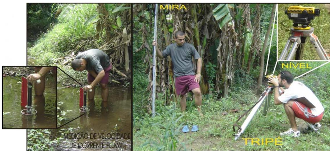
**Figura 04:** a) (esquerda) Medição de velocidade da corrente fluvial com correntômetro; b. (direita) Perfilagem transversal do leito fluvial.
