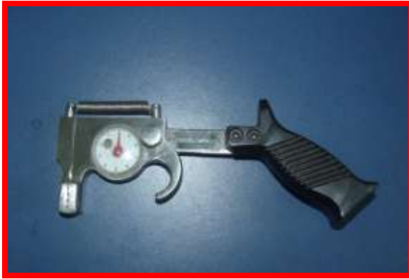
Figura 3: Cutímetro analógico com visor tipo relógio modelo alemão.
