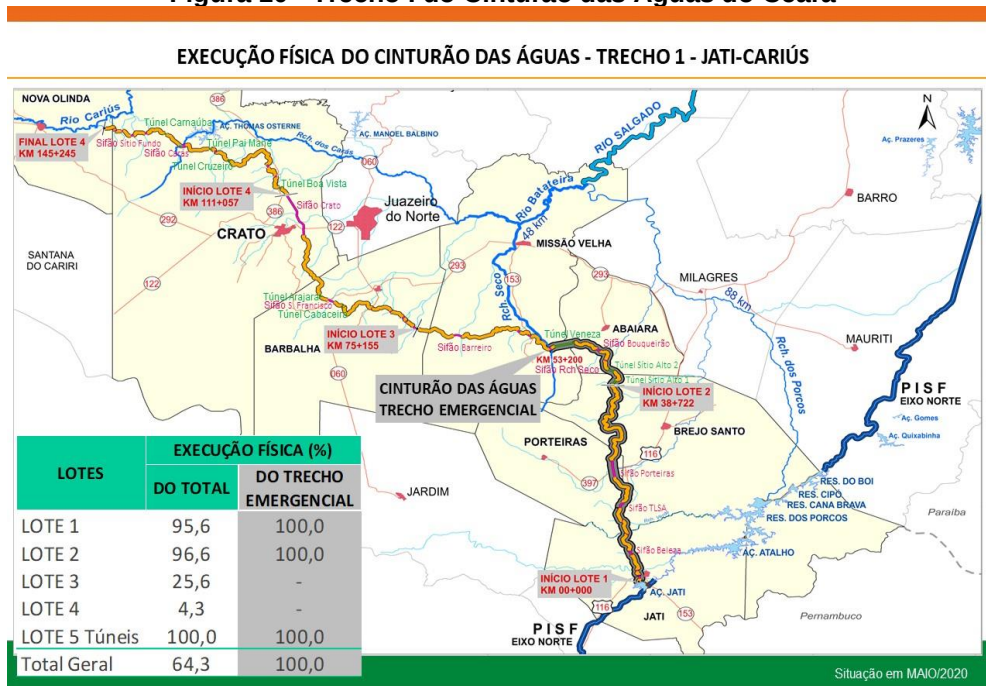
Figura 10 - Trecho I do Cinturão das Águas do Ceará
