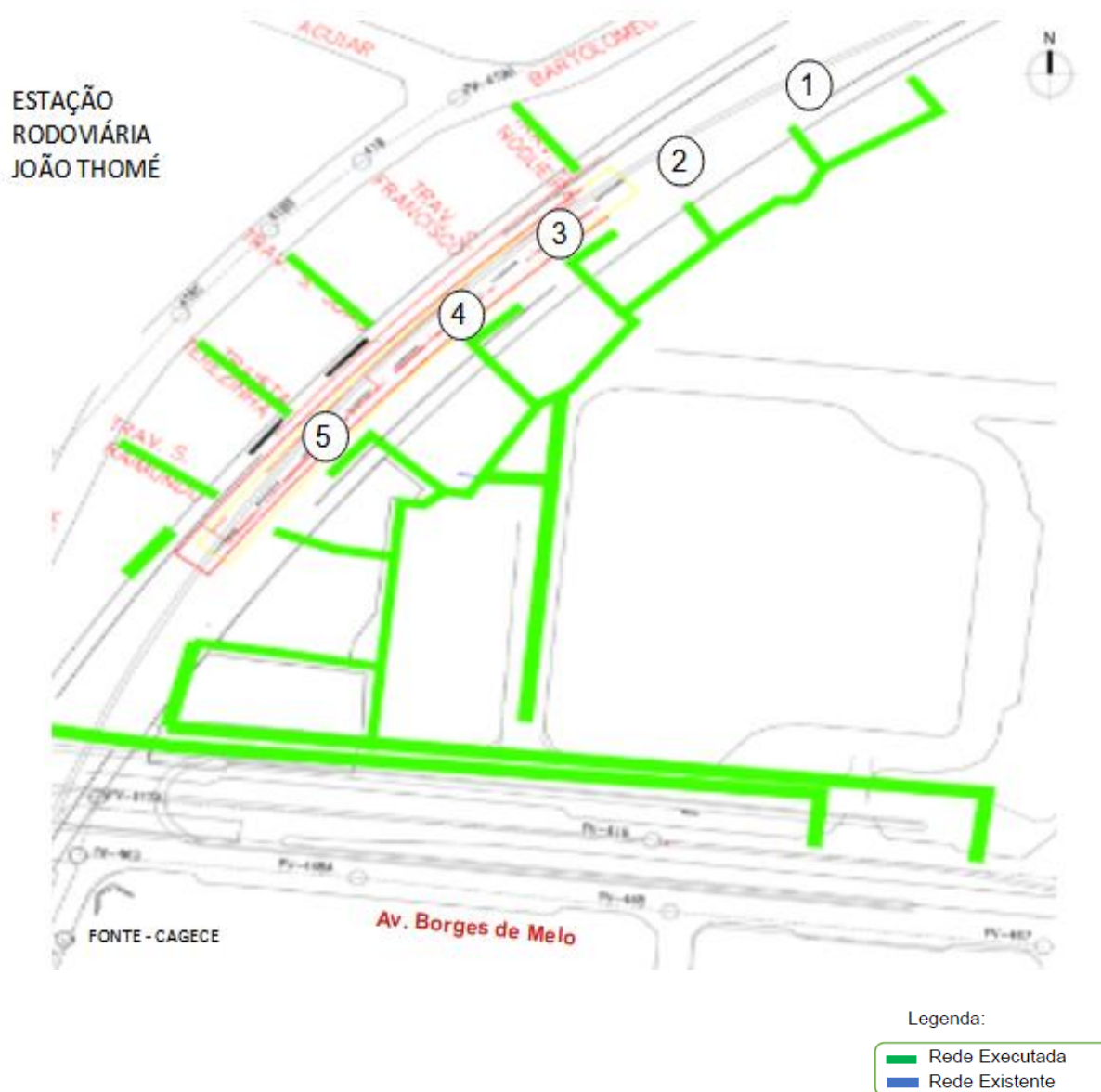
Figura 152 - Planta da rede executada (Aldaci Barbosa) - CAGECE
