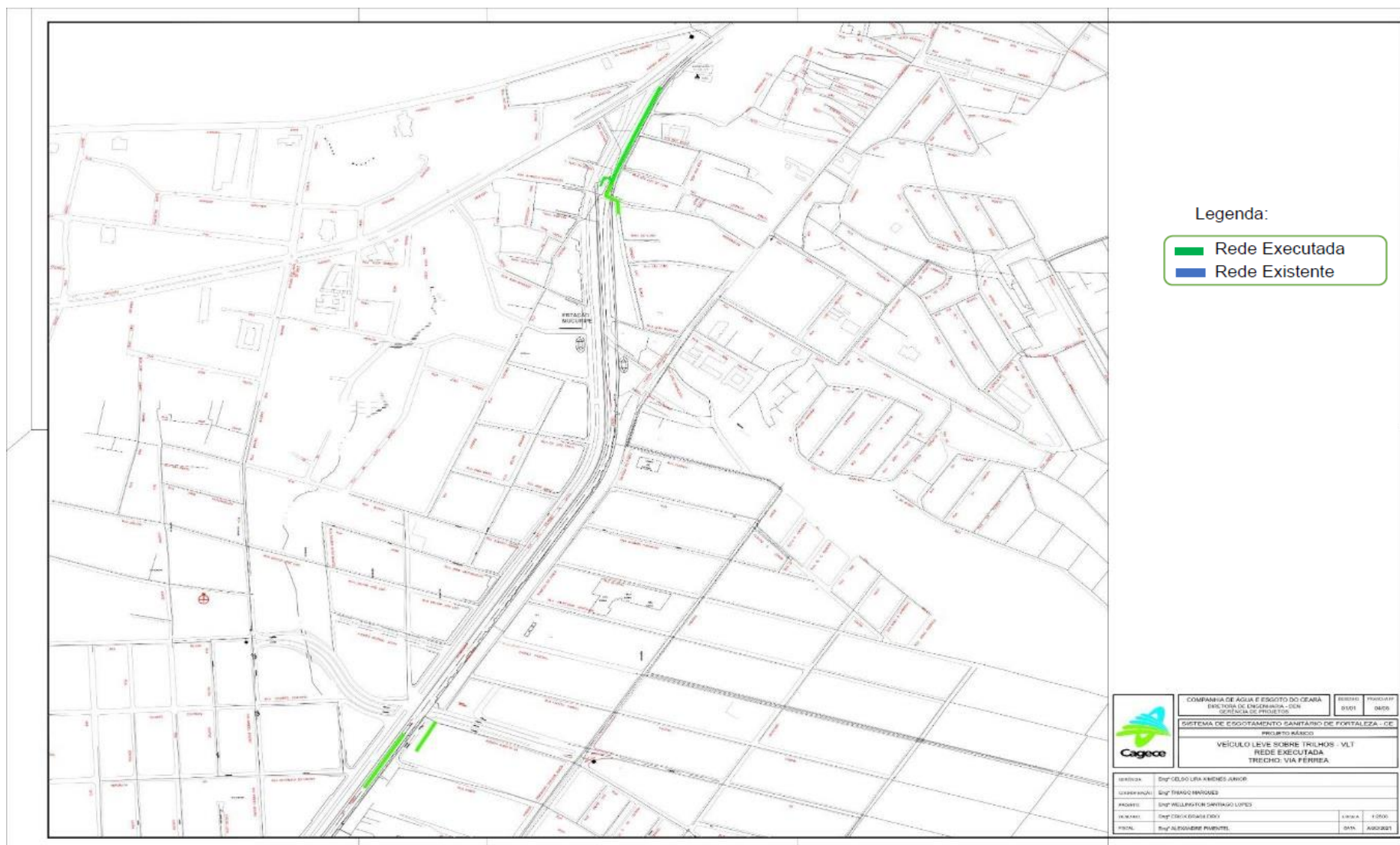
Figura 126 – Planta do trecho implementado (Via Férrea)
