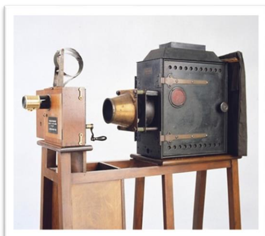
Figura 26 – Cinematógrafo dos irmãos Lumière, equipamento de gravação e projeção de imagens
