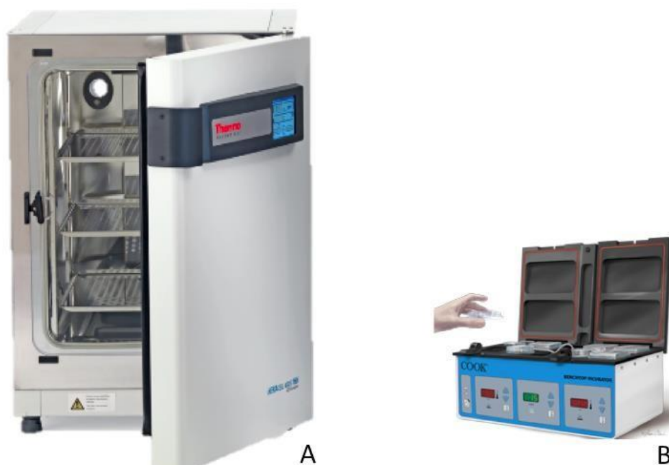
Figura 2 - Modelos de incubadoras utilizadas no cultivo in vitro de embriões bovinos. A: modelo convencional com grande volume. B: modelo mini de bancada utilizando mistura de gases.
