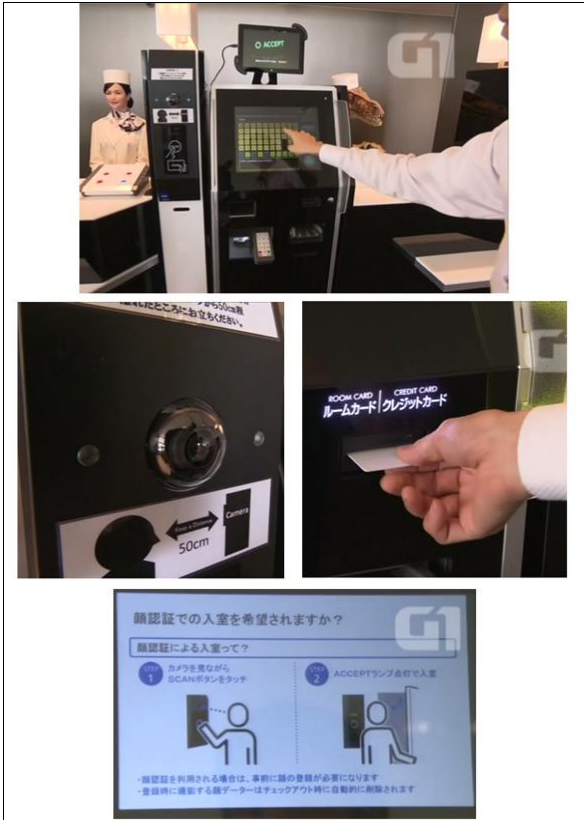
Figura 15 – Terminal touch screen onde hóspede executa o autosserviço
