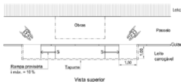
Figura 98 — Rampas de acesso provisórias
