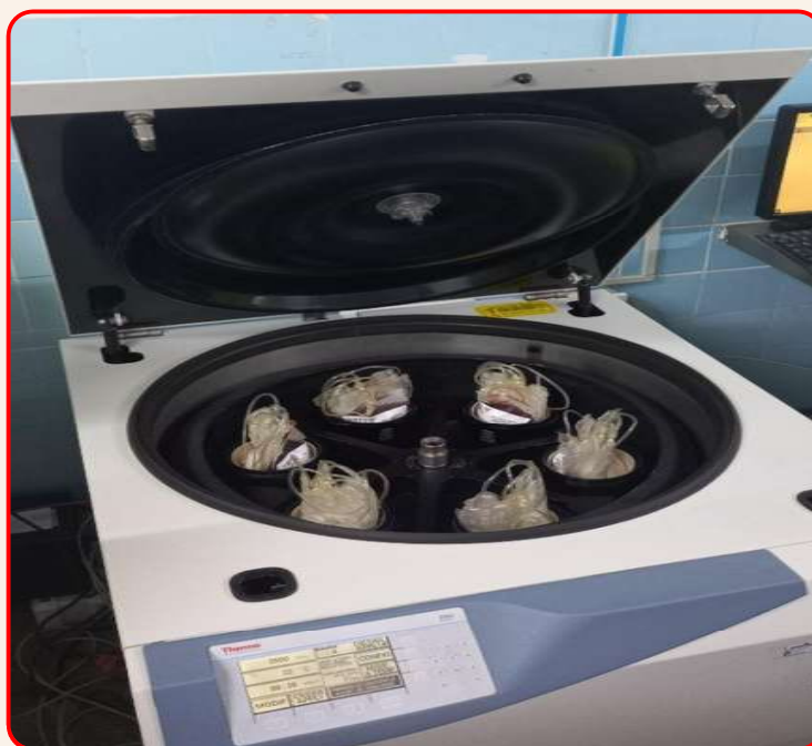
Figura 8 - Centrifugação de sangue total realizada em centrífuga KR 4i refrigerada
