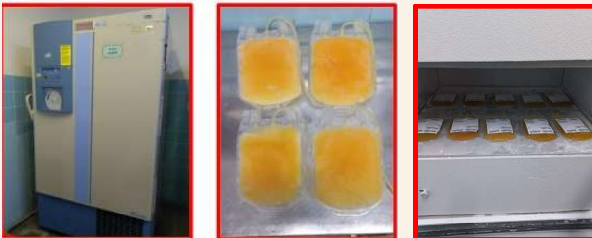
Figura 14 - Ultrafreezer usado para congelamento rápido do plasma
