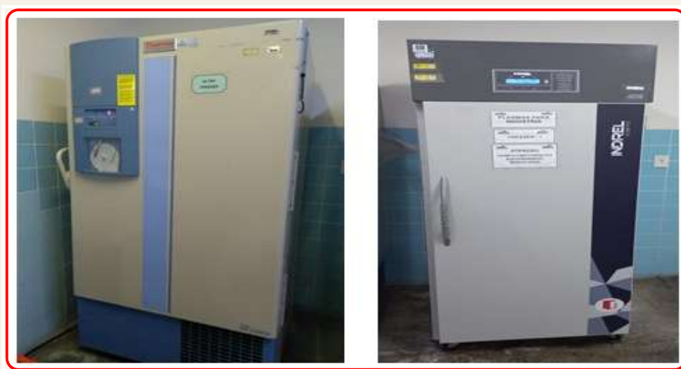
Figura 22 - Equipamentos ultrafreezer 85 graus negativos e freezer 30 graus negativos usado para congelamento rápido e armazenamento de plasma e CRIO
