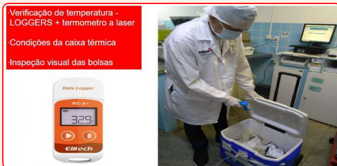
Figura 6 - Controle e monitoramento de temperatura das bolsas de sangue total
