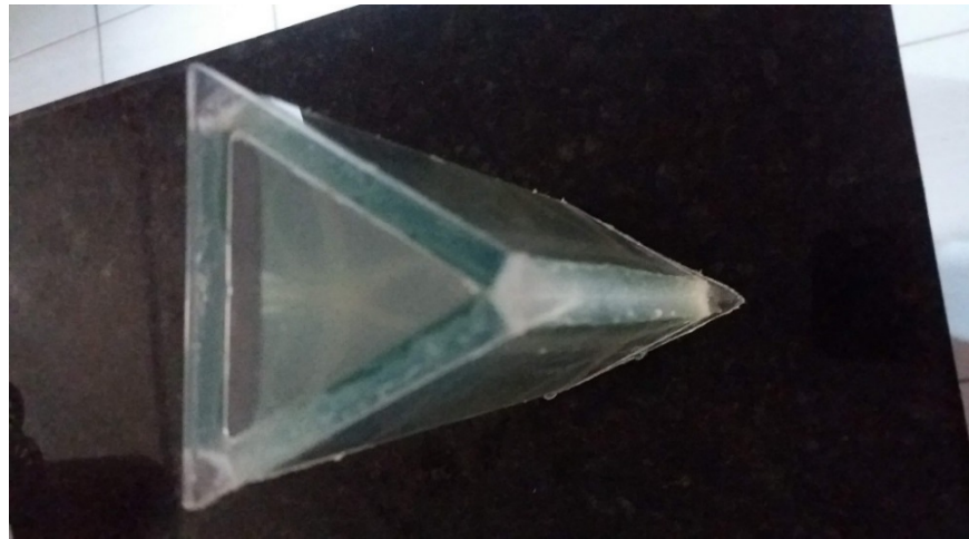
Figura 17 – Foto do prisma construído de base triangular
