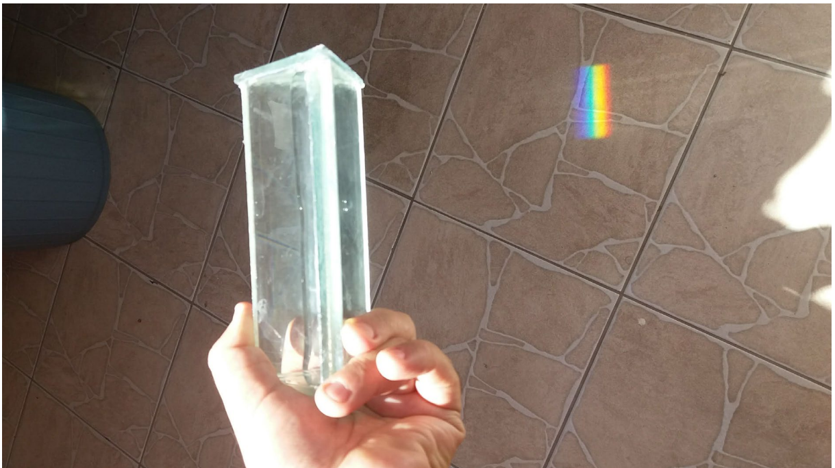
Figure 18 - A imagem mostra a refração e dispersão da luz solar pelo prisma
