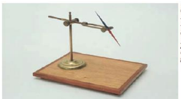
Bússola de inclinação magnética.
