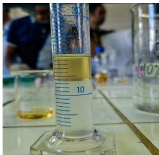
Figura 2 - Prática: Determinação do teor de álcool na gasolina
