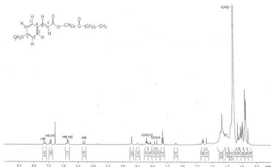
Figura 12: Espectro de RMN 1 H do PCO-C (diésteres do ácido 4-metoxicinâmico 500 MHZ, CDCl 3 ).
