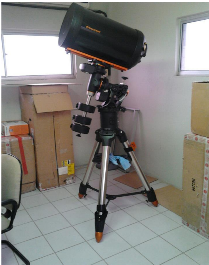
Fotos 10 e 11 – O telescópio CGE Pro 1400 linha EDGE e a câmera Sony- α NEX-C3, são dois dos principais equipamentos adquiridos, sendo possível acoplar a câmera ao telescópio para captação de imagens planetárias e possivelmente imagens de DeepSky.
