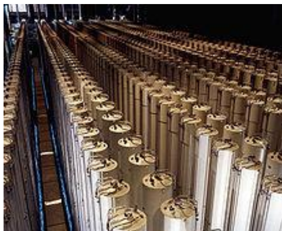
Figura 5 – Cascata de centrífugas a gás em uma usina de enriquecimento.
