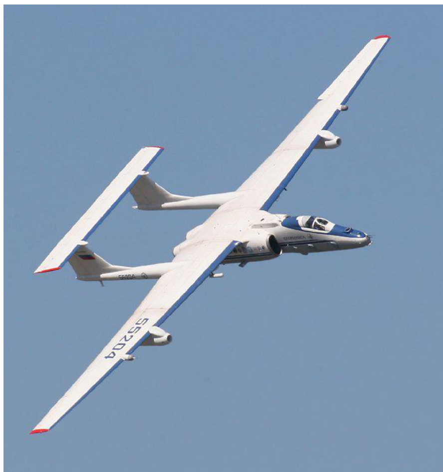
Figura 7 – Aeronave estratosférica M-55 Geophysica
