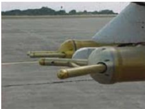
Figura 21 - OAP-200Y (em primeiro plano) e OAP 200-X (em segundo plano) instaladas na plataforma ALPA
