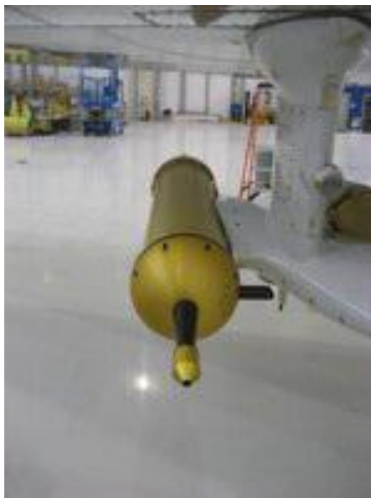
Figura 14 - Ultra-High Sensitivity Aerosol Spectrometer (UHSAS) instalado no HIAPER
