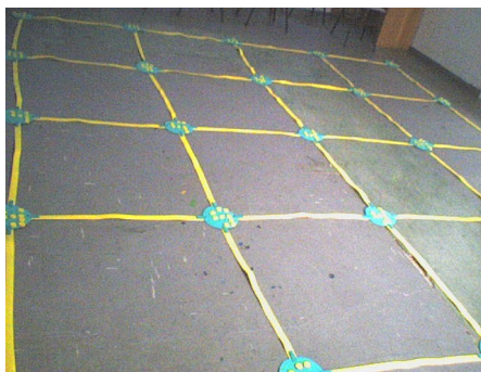
Figura 27 – Tiras coladas aos pontos de intersecção formando a malha. Fonte: Produção do autor
