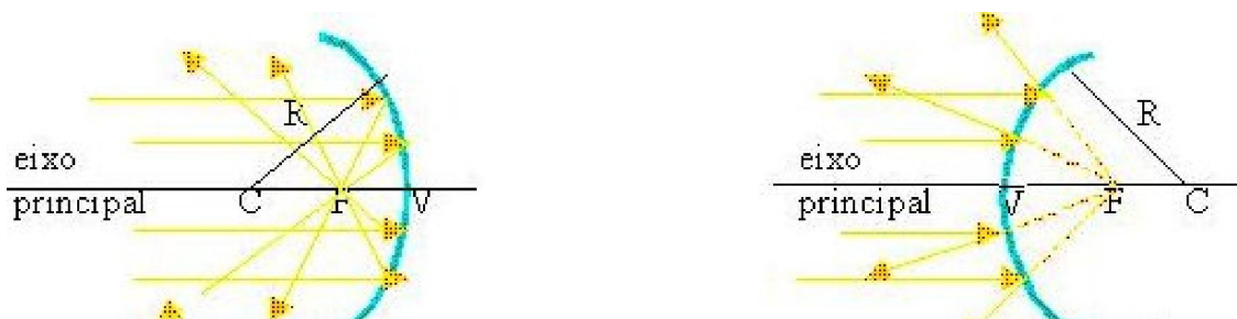
Figura 13 – Espelhos côncavo e convexo. Fonte: http://educar.sc.usp.br/optica/ .
