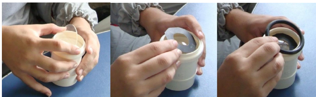
Figura 25 – Encaixando a lente objetiva, o diafragma e o anel de borracha.
