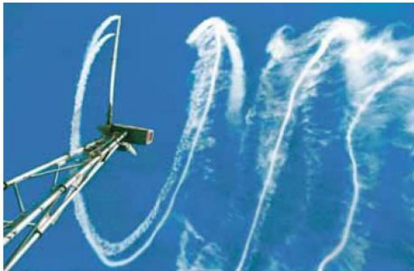
Segundo Castro (2007), devido a essa perda de energia como consequência do efeito esteira, o posicionamento de aerogeradores em parques eólicos deve ser prudente. O espaçamento mais frequente entre aerogeradores é entre três e cinco diâmetros na direção perpendicular ao vento e na mesma direção do vento, esse espaçamento deve ser entre cinco a nove diâmetros (figura 3.5).
