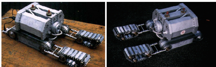
Figura 34: O robô construído na Universidade Carnegie Mellon nos Estados Unidos para fazer inspeções do interior de tanques e reservatórios de combustíveis (Fellipe de Souza)
