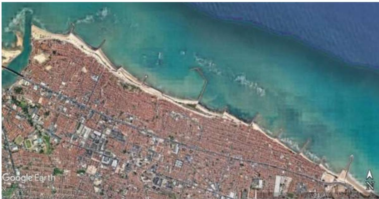
Figura 39 – Molhes de proteção costeira construídos no litoral oeste de Fortaleza. Fonte: Google Earth, 2018. Adaptado pelo autor.
