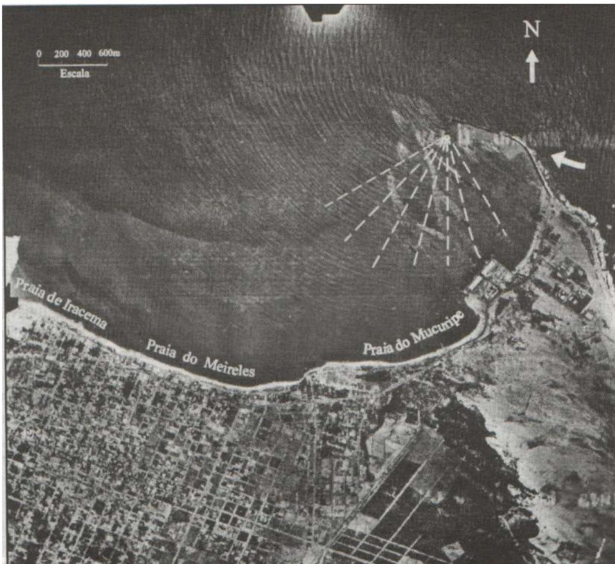
Figura 9 – Difração das ondas no molhe do Porto do Mucuripe. Fonte: Moraes, 1972; Pitombeira, 1976.
