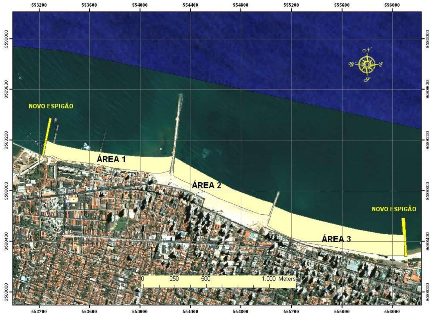
Figura 43 - Layout da solução final para recuperação da área. Os novos espigões (no Poço da Draga e defronte a Avenida Desembargador Moreira) e a área 1 já foram construídos. Fonte: GEOLÓGICA, 2011.
