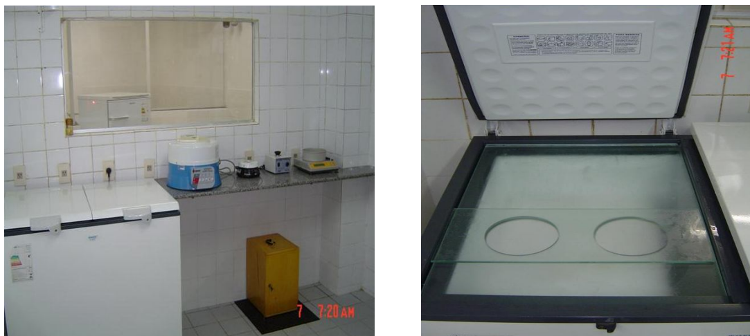
Figura 5 – Freezer utilizado para o envase das amostras. Temperatura interna de 4\text{ }^{\circ}\text{C} .
