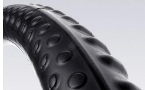
A superfície do pneu na verdade é visivelmente diferente dos pneus tradicionais, com pequenas protuberâncias voltadas para fora, que impedem que o pneu entorte. As protuberâncias também ajudam no processo de autorregeneração, por fazerem a borracha se comprimir (em vez de se expandir e piorar o furo). A pressão do ar deveria fechar o buraco, pelo menos na teoria, e o material para vedação selaria o furo de vez.
