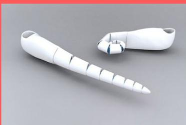
Para agarrar o objeto, o usuário pode ajustar a quantidade de curvas do tentáculo através de dois botões que acionam um motor aumentando ou diminuindo a curvatura usando dois cabos que percorrem o braço.
