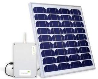
Pesquisadores do Laboratório de Sistemas Integráveis (LSI) da Escola Politécnica (Poli) da USP criaram o protótipo de um sistema de comunicação sem fio em malha alimentado por energia solar.
