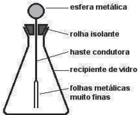
Figura 2 – Exemplo de eletroscópio de folhas
