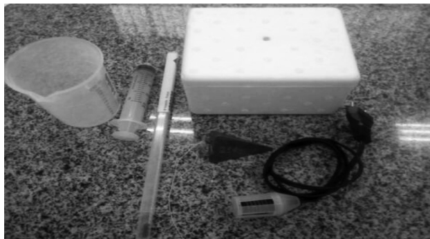
Figura 4 – Kit experimental para determinação do calor específico
