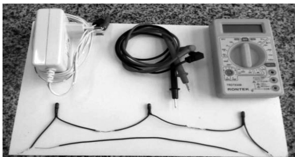
Figura 5 – Aparato experimental para experimento de circuitos resistivos
