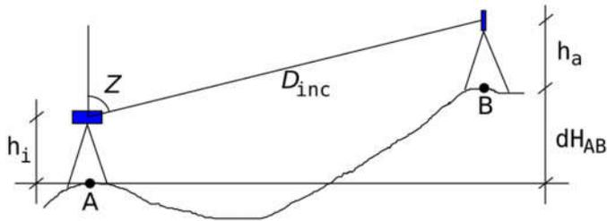
No intuito de determinar a profundidade para a construção de um túnel para escoamento de águas pluviais, um topógrafo coletou os seguintes dados:
